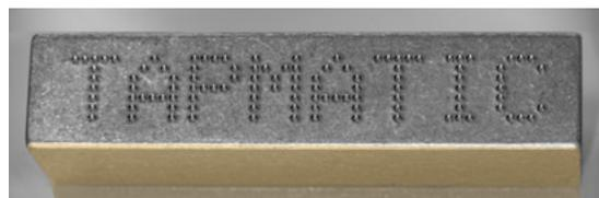
Programmazione punto a punto per la creazione di caratteri in posizione definita o codici dati 2D.
