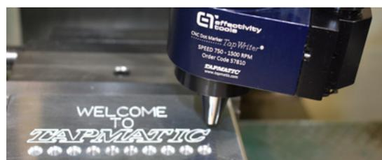
Marcare i loghi usano il software CAD/CAM per il percorso dello strumento.
