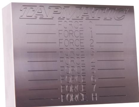
Esempio in 4140 materiale pre-trattato con durezza 28 HRC. Marcatura a diverse impostazioni con compressione da 1,3 mm contro la superficie.
